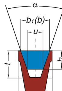
Für BEHAbelt-Keilriemen nach DIN 2215 sind Keilriemenscheiben nach DIN 2217 zu verwenden.
