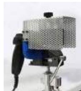
**Verbrennungsschutz für stationären Betrieb**
