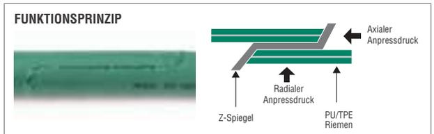
Kompakte Führungseinheit für Überlappverschweißungen mittels Z-Spiegel mit radialem und axialem Anpressdruck.
