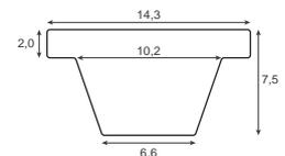
Empf. Vorspannung: 3...6 %, **Reibwerte  $\mu$** : Stahl: ca. 0,65 | PE: ca. 0,35 | HDPE: ca. 0,30 | **FDA/EC/USDA-konform**
