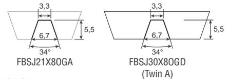
Reibwerte  $\mu$ : Stahl: ca. 0,65 | PE: ca. 0,35 | HDPE: ca. 0,30 | FDA/EC/USDA-konform
